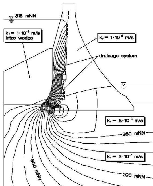
**Fig. 10: Seepage Flow Analysis Equipotential Lines**
